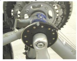
Ensuite vous devez installer le capteur proprement dit. Trouvez la zone du cadre la plus adaptée pour l'installer. La tête du capteur (petite partie circulaire) doit tomber en face du cercle des aimants du disque.
