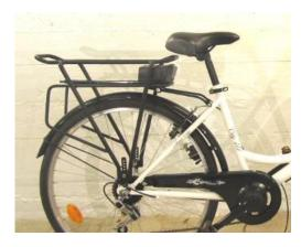
Si votre batterie est du type porte bagage, le contrôleur s'installe dans le logement prévu à cet effet en avant de la batterie, protégé par un capot plastique fermé par deux vis et deux clips. Pensez à raccorder les différents câbles avant de refermer le capot (voir chapitre suivant).
