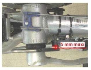
Certains capteurs possèdent un autocollant double face qui vous permet de le fixer provisoirement en attendant sa fixation définitive à l'aide des colliers nylon fournis.
