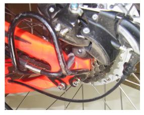
Les rondelles anti-rotation sont à positionner à l'intérieur ou à l'extérieur du cadre, le méplat toujours vers l'intérieur de la gorge. Les rondelles de calage peuvent également être positionnées d'un côté ou de l'autre afin d'aider à centrer au mieux la roue. Vérifiez bien que le moyeu ne frotte pas sur le cadre.
